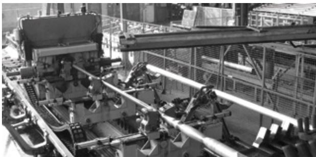
Cette machine est composée d'une broche et d'une contre pointe ce qui permet de mettre en rotation l'ébauche. Un chariot formeur composé de galets spécifiques se déplace sur le bâti et conforme le produit suivant les spécifications techniques programmées dans la machine.
