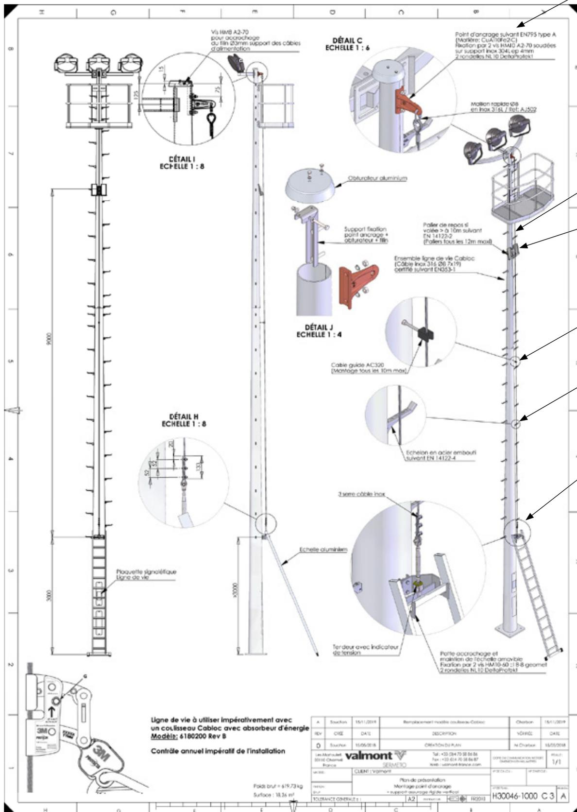
Point d'ancrage en partie haute du mât.
