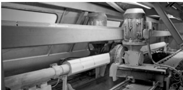
Les mâts de section cylindrique sont effectués sur ce même centre d'usinage pour obtenir dans un premier temps une section composée d'une multitude de facettes.
