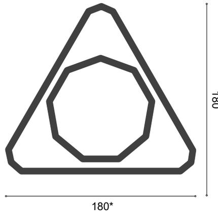
**Trimorph', c'est une déclinaison autour d'une section triangulaire à 9 pans. En version Totem avec sa section régulière ou en version Conik évolutif pour un éclairage top, Trimorph' est une vision contemporaine du support d'éclairage.**
