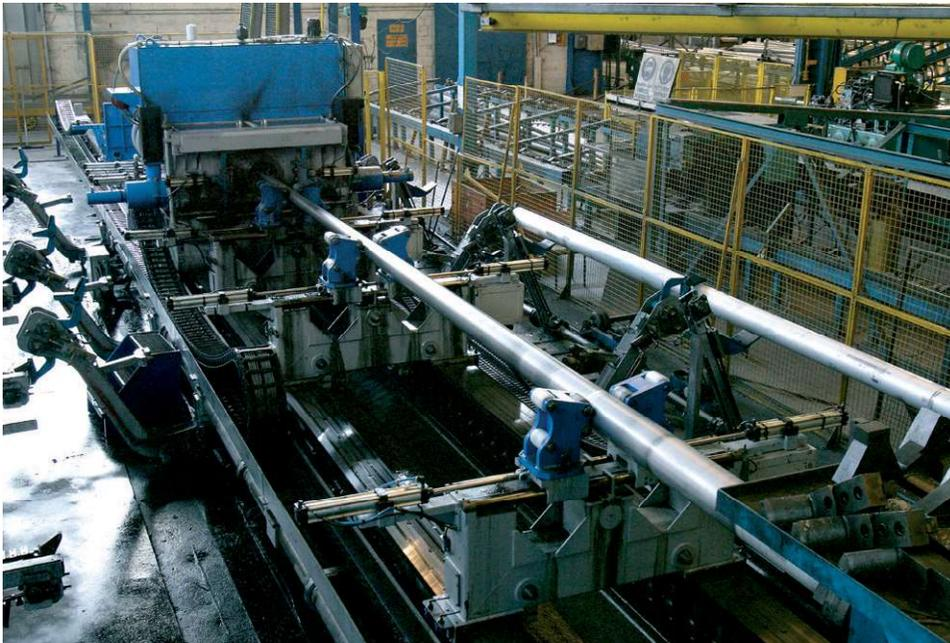
Cette machine est composée d'une broche et d'une contre pointe ce qui permet de mettre en rotation l'ébauche. Un chariot formeur composé de galets spécifiques se déplace sur le bâti et forme le produit suivant la définition technique programmée dans la machine.
